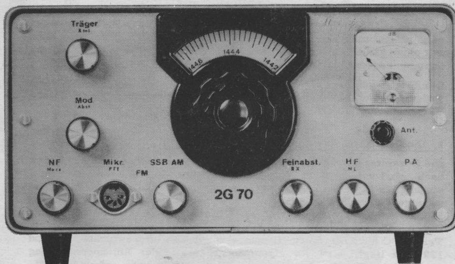
Ein SSB-AM-CW-Transceiver für das 2-m-Band
